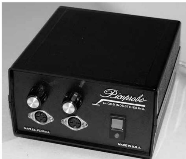
MODEL PS-3は、ピコプローブの内蔵素子を電氣的に保護し、安定した測定が行えるように設計されています。2本のピコプローブを同時につなげて使用できます。
